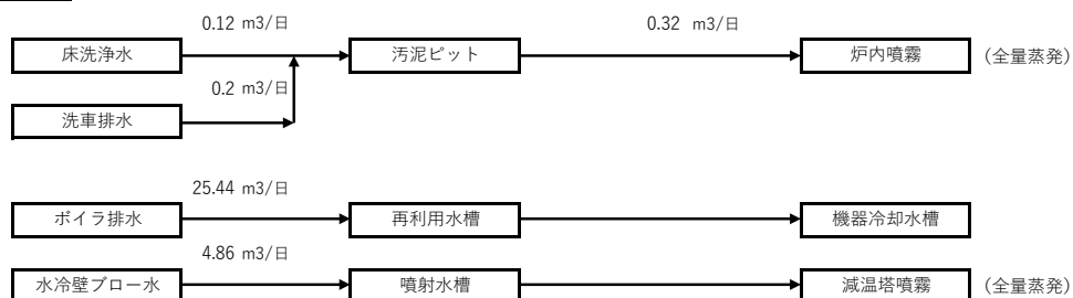
図 2.7.5-1 給排水フロー図
